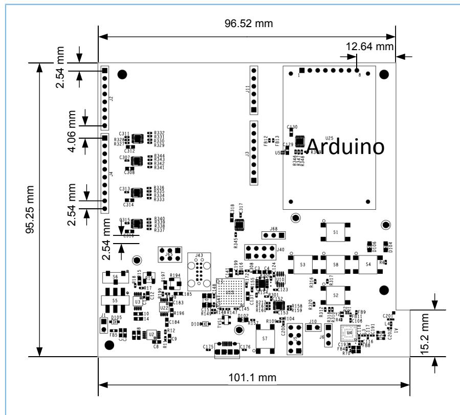
图 11-1 GR5515 SK 板尺寸图（顶视图）
