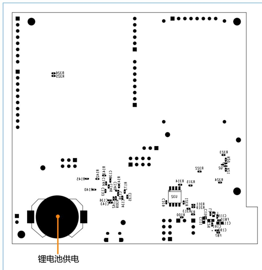
图 5-2 电源供电 (底层图)
