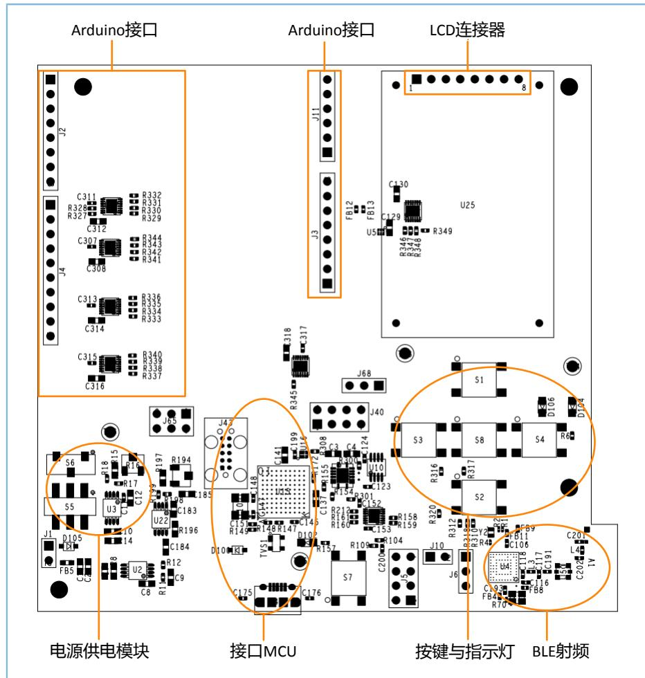
图 3-1 GR5515 SK 板的硬件布局（顶层图）
