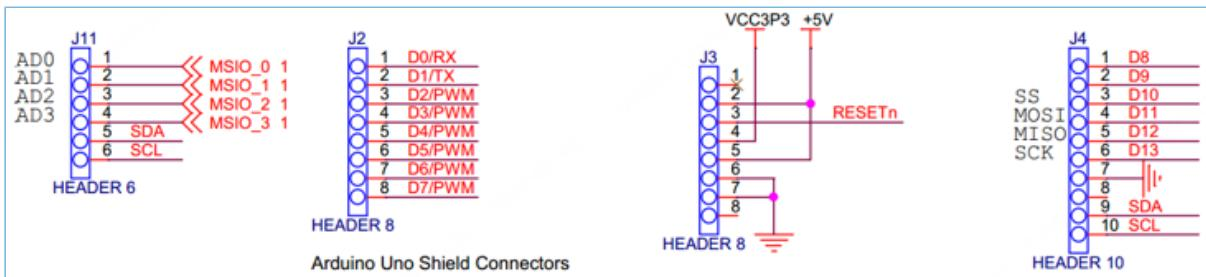
图 6-1 GR5515 SK板Arduino接口
