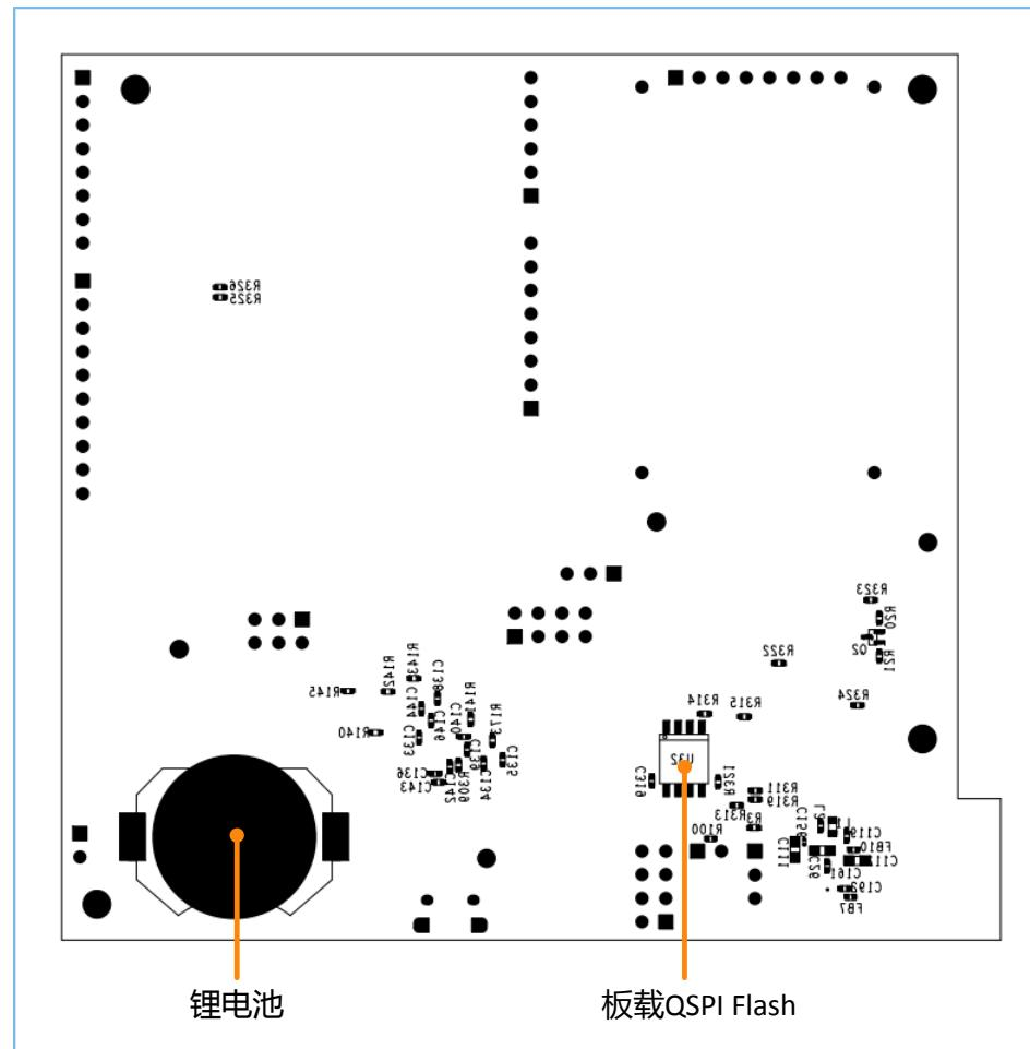
图 3-2 GR5515 SK板的硬件布局（底层图）
