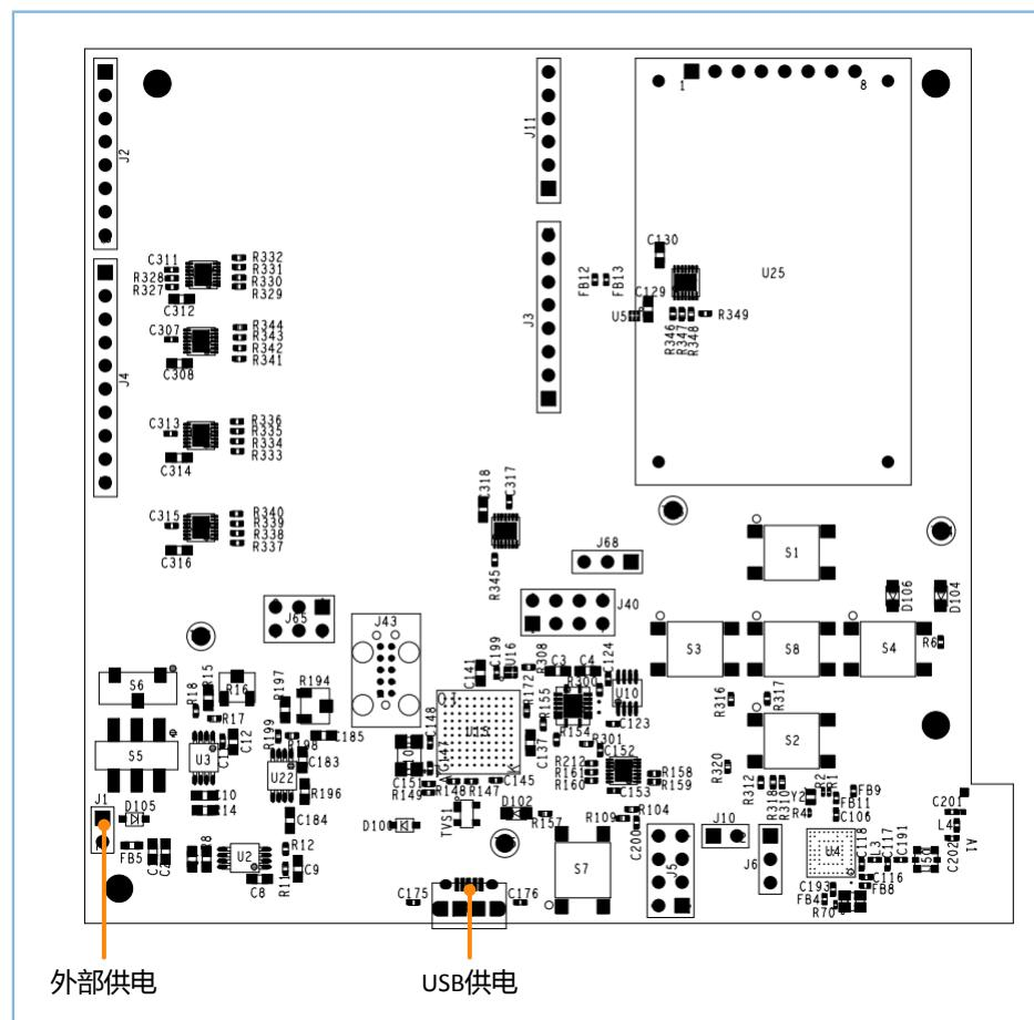
图 5-1 电源供电（顶层图）
