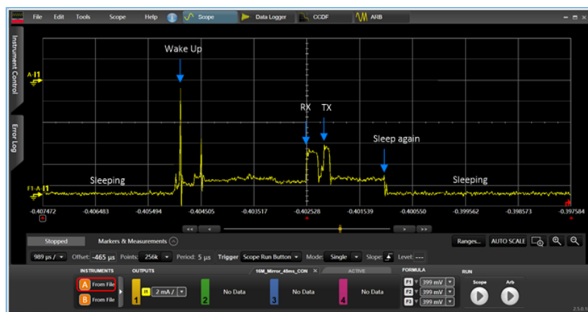
图 5-4 开发板连接业务功耗测试波形
