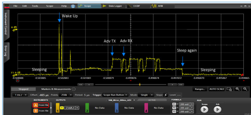
图 5-3 开发板广播业务功耗测试波形
