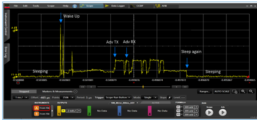
图 4-3 开发板广播业务功耗测试波形
