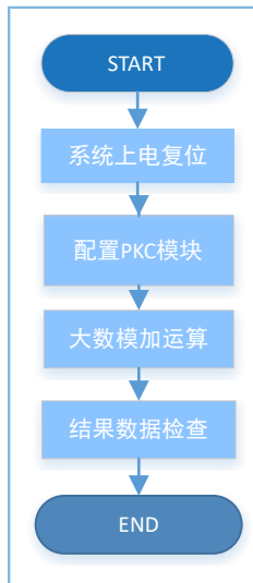
图 3-21 PKC示例工程流程图
