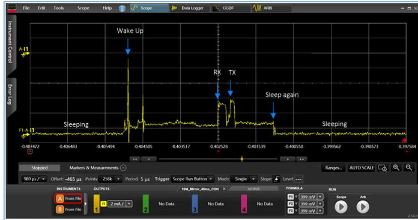
图 5-4 开发板连接业务功耗测试波形
