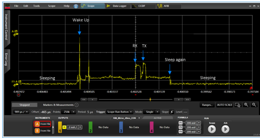
图 4-3 开发板连接业务功耗测试波形
