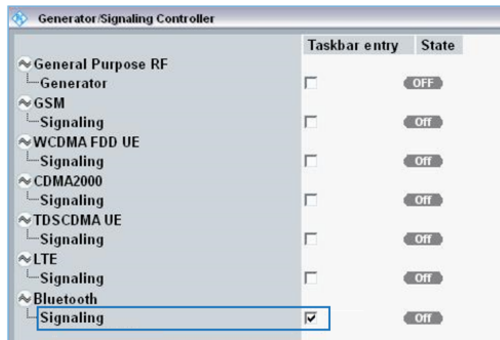
图 3-10 CMW500信令测试配置
