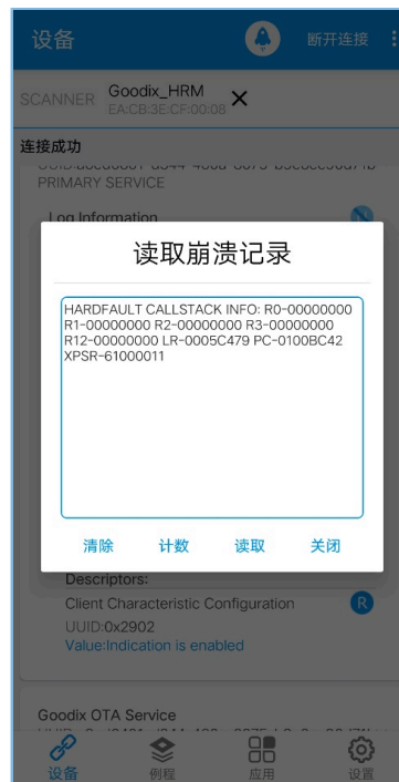
图 3-13 蓝牙连接读取Fault Trace Data
