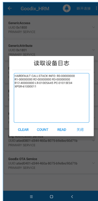
图 3-13 蓝牙连接读取Fault Trace Data
